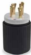
CLAVIJA DE SEGURIDAD CON SEGURO ( GIRAR - TRABAR) TWIST LOCK 3P. 4H 125/250 V, 30 A
