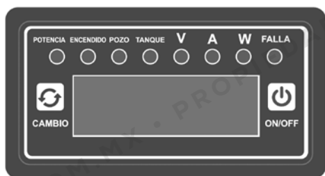
Figura 02. Pantalla SOLAR-MONIT-025 o SOLAR-MONITOR
